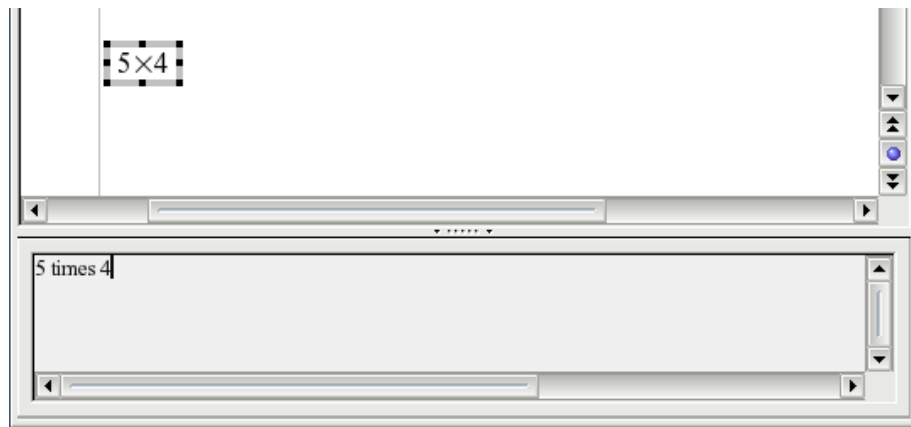
Figura 5: Inserimento di "5" e "4" come operandi dell'istruzione "times" (moltiplicazione)
